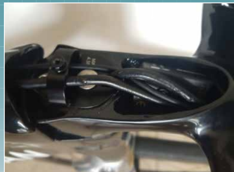
Le contrôleur Di2 enfoui et les passages de gaines internes
