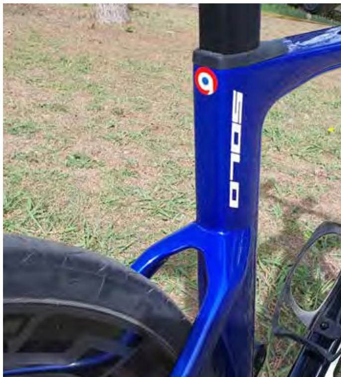
L'intégration des câbles est très propre, contribuant au look très épuré du SOLO. Elle contribue également aux performances aérodynamiques du vélo. Fort heureusement, cela ne se fait pas au détriment de la simplicité d'assemblage et d'entretien du SOLO d'un point de vue mécanique. On apprécie que le design du SOLO soit le fruit d'une réflexion aboutie pour en faire un vélo destiné à un usage intensif en compétition.
